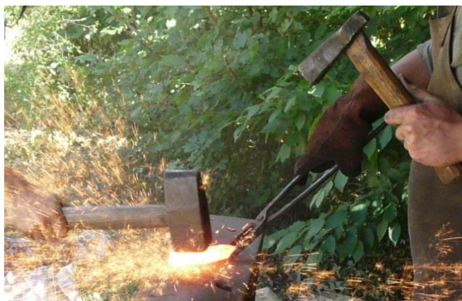
Soudure loupe de fer, West Side Team, © Maxime L'Héritier
